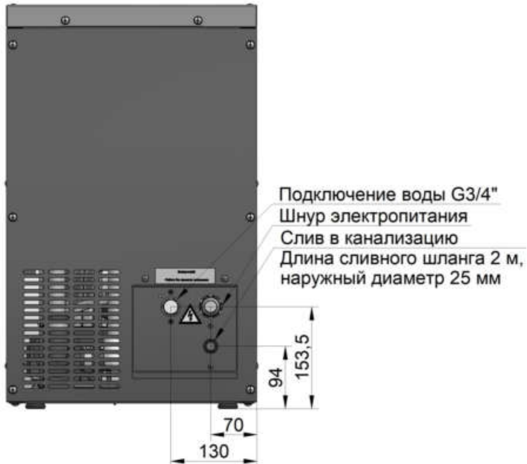
Рис. 5 Схема подключения льдогенератора
