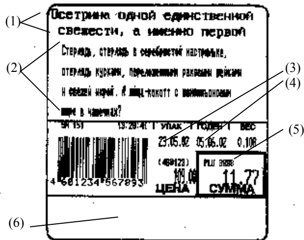
Рис. 6. Пример печати этикетки формата 7. Этикетка размером 58 x 60 мм, с препринтом. (1) – две строки наименования товара; (2) – четыре первые строки сообщения; (3) – дата упаковки; (4) – срок годности; (5) – номер товара; (6) – поле текста “магазин” отсутствует.
