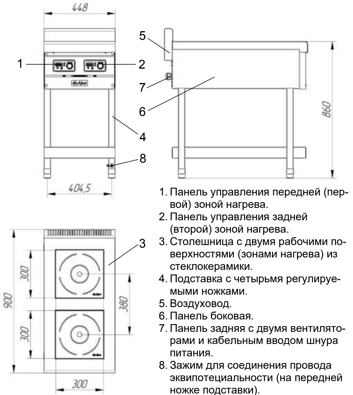
Рис. 1. Общий вид и размеры плит КИП-29П-3,5, КИП-29П-3,5-01, КИП-29П-5,0, КИП-29П-5,0-01
