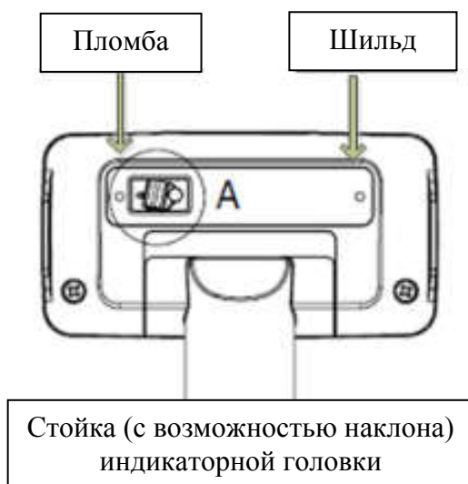
Рисунок 14.1 – Расположение поверочной пломбы весов
