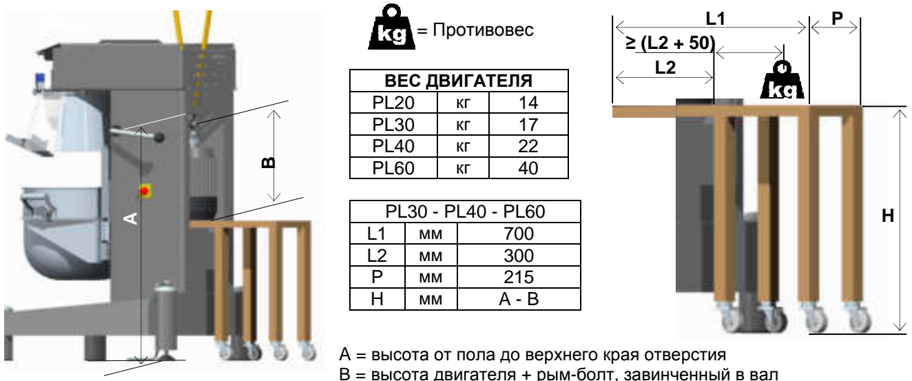
Рисунок 21– Инструмент для упрощения процедуры установки/демонтажа двигателя
