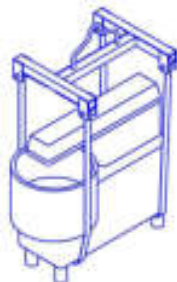
Рисунок 2 - Схема строповки машины тестомесильной МТ-30
