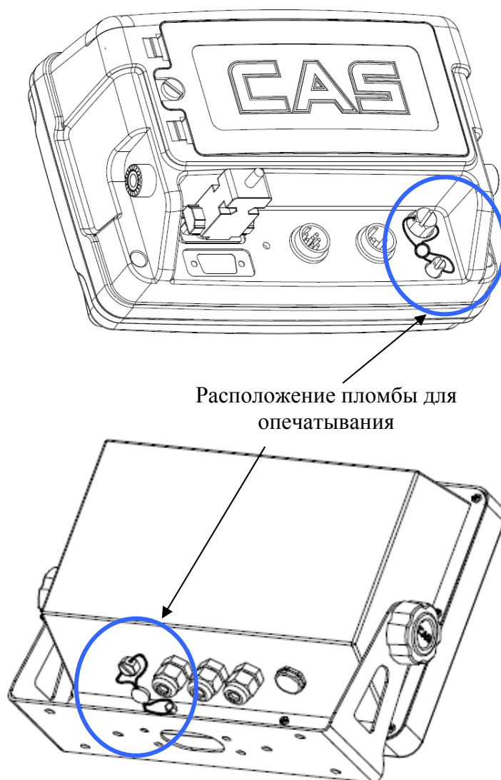
Рисунок 14.1 – Расположение поверочной пломбы индикатора
