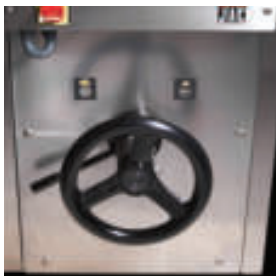
Рукоятка для регулировки веса тестовых заготовок Позволяет точно и быстро регулировать вес.
