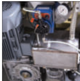
Система рециркуляции масла Позволяет значительно сократить расход масла. Оснащена патронным фильтром и сигнализацией низкого уровня. Наполнение снаружи.
