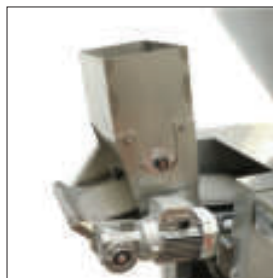
Автономный посыпатель муки Позволяет избежать приклеивание тестовых заготовок к ленте.
