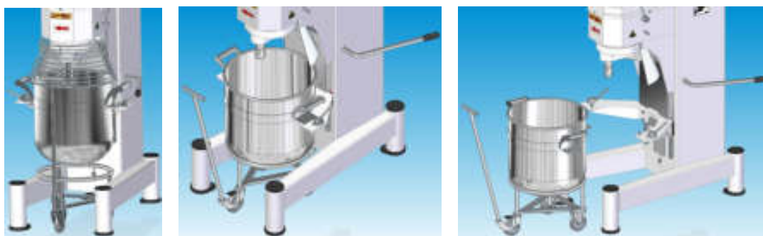
Рис. 6 Установка/извлечение дежи при помощи тележки
