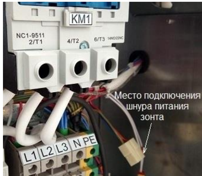
Рис.1 Подключение шнура питания зонта к колодке 45.7373.9005 пароконвектомата
