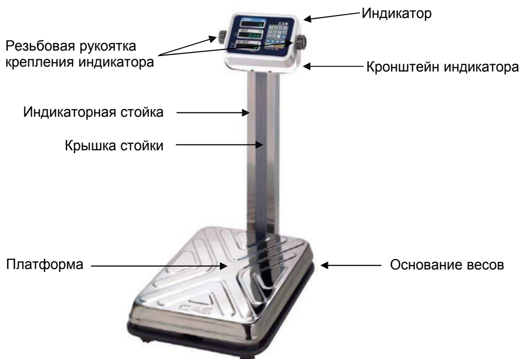
Рис. 1 Общий вид, основные конструктивные элементы
