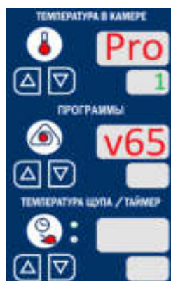
Рис. В. Вывод информации на индикаторы
