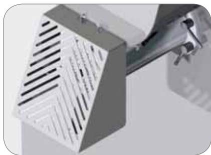
1. Opzionale: sistema di protezione interbloccato per uso piastre con foro > 8 mm. Optional: interlock protection for more than 8 mm holes plates.
