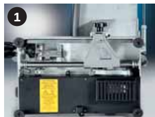
1 - Protezione inferiore Underside motor protection plate
