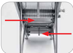
1. Leve regolazione spessore di taglio Cutting width adjustment levers
