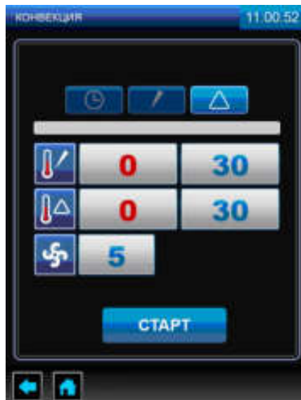
Рис.21 Режим «КОНВЕКЦИЯ» с использованием параметра «ДЕЛЬТА»
