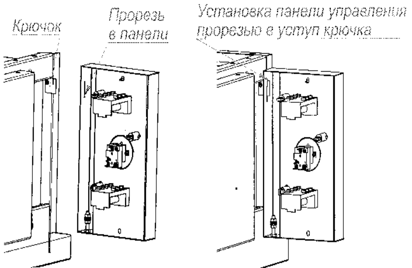
Рис. 11. Технологическое окно для замены контрпетли.
